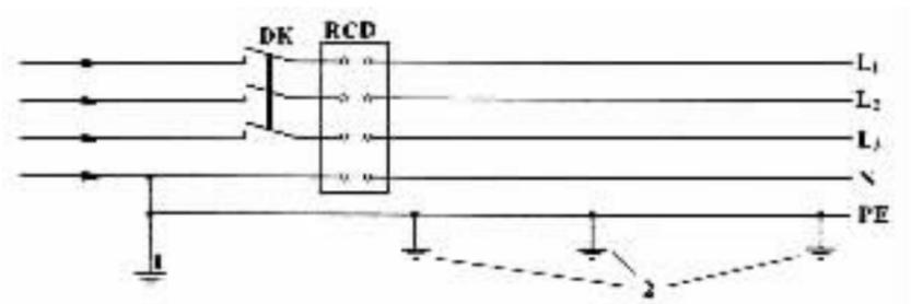
图 5. 1. 2 三相四线供电时局部 TN - S 接零保护
